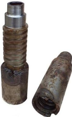
**4. Переходник фрезерный (П1-50/89) (геологоразведочное бурение):**
