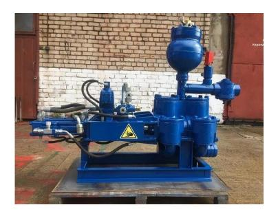
Для осуществления работы бурового насоса НБГ-50 необходимо наличие масло станции для подачи гидравлической жидкости в гидроцилиндры передвижения штоков.
