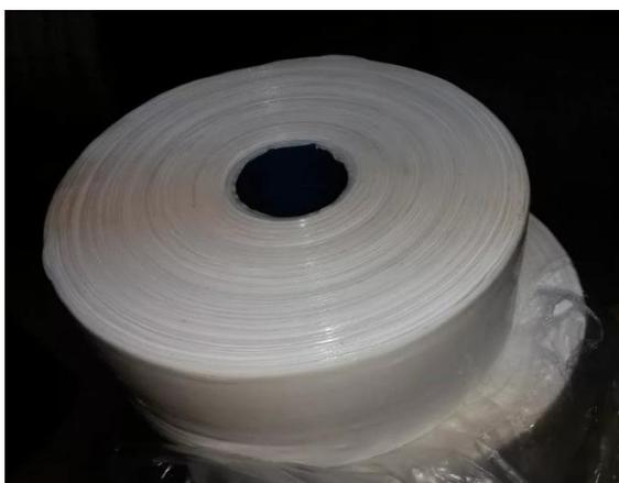
ФУМ лента марка 1 ТУ 6-05-1388-86. Маслобензостойкий, антикоррозийный, самосмазывающийся, нетоксичный, термо и химически стойкий уплотнительный материал, изготавливаемый из фторопласта-4Д. Предназначен для уплотнения неподвижных резьбовых соединений трубопроводов из всех материалов. ФУМ - лента применяется для уплотнения систем со средами общепромышленного типа, а также
