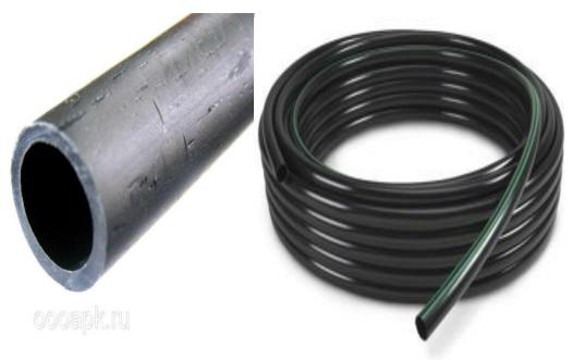
Труба имеет гладкую внутреннюю и наружную поверхности. Не допускаются вкрапления, видимые невооруженным взглядом. Цвет трубы - черный, черный с синими продольными полосами, нанесенными равномерно по окружности трубы, или синий. Маркировка обязательно содержит ГОСТ, диаметр, SDR трубы и данные завода-изготовителя.
